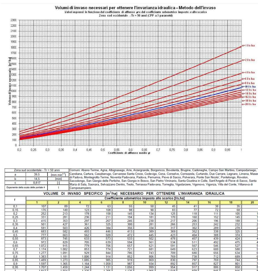
Figura 4: Linee Guida- Volumi di invaso per Criterio di dimensionamento 1, Zona Sud occidentale, CCP 3 parametri.
